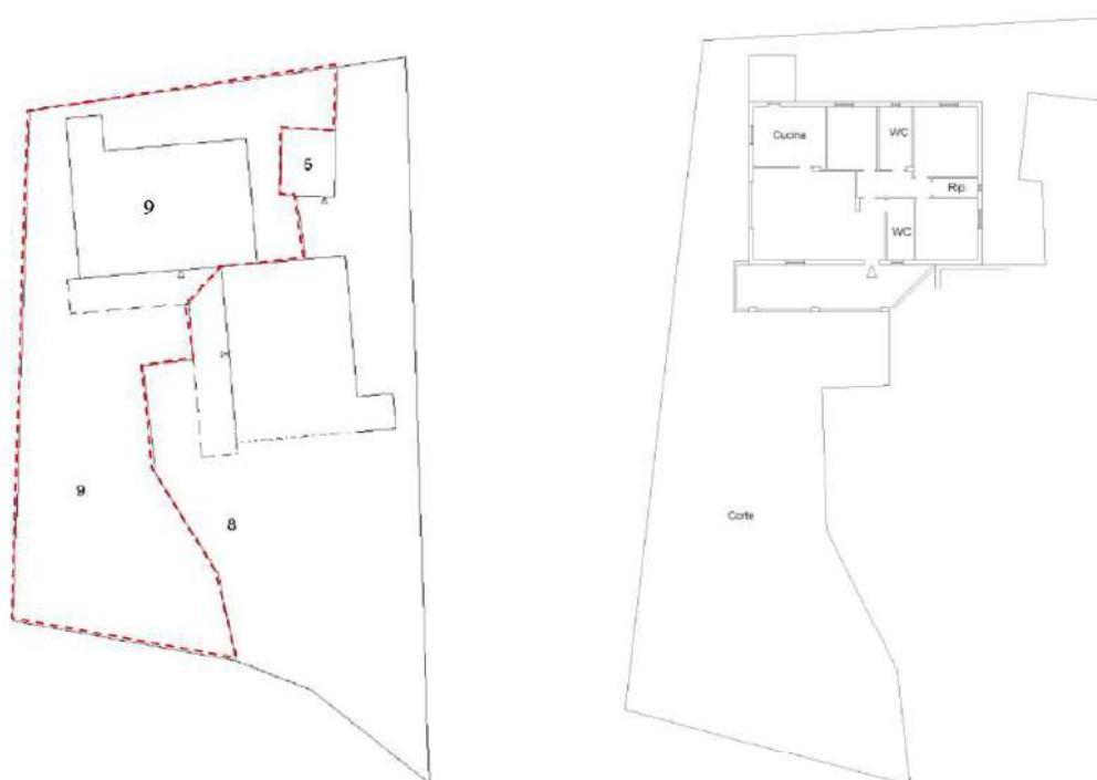
Fig. 4 – ELABORATO PLANIMETRICO E PLANIMETRIA CATASTALE DELL'APPARTAMENTO SUB 9 NEI QUALI NON RISULTA IL LOCALE DEPOSITO REALIZZATO IN ADERENZA AL SUB 5 DI ALTRUI PROPRIETA'.
